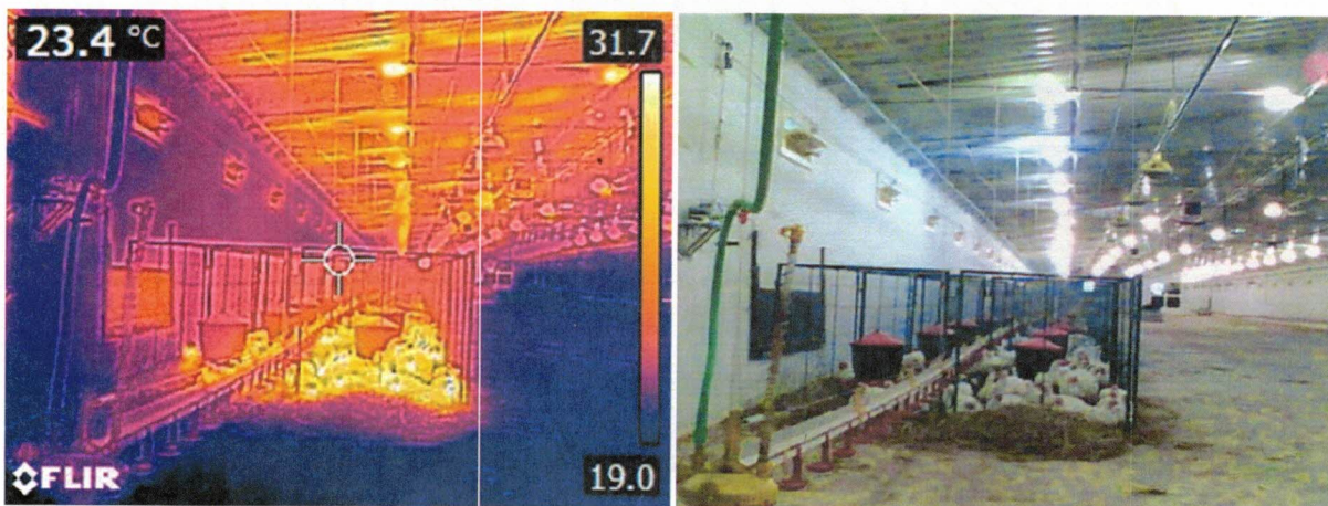
Fot. 1 Obraz z kamery termowizyjnej (po lewej) i standardowo (po prawej)- ogólny wygląd kurnika doświadczalnego
