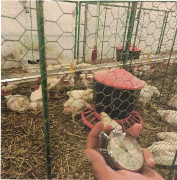
Fot. 3. Pomiar ochładzania bioaklimatycznego z wykorzystaniem katatermometru Hilla
