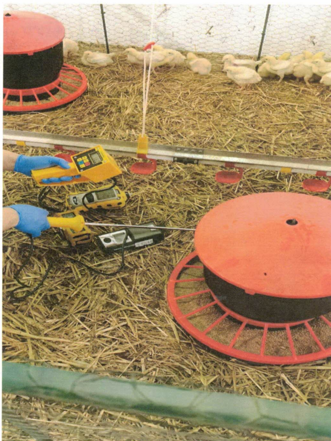
Fot. 2. Badanie stężenia gazów oraz parametrów ściółki
